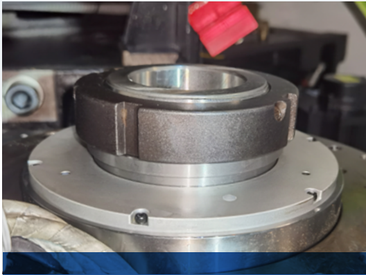
安装在 车铣复合电主轴 上的 SAE 170
